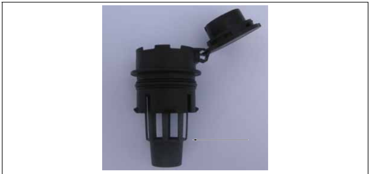
Figur 56: Batteriets påfyllingshals (demontert) sett fra siden. Etterfyll til angitt nivå ETTER lading av batteriet.
