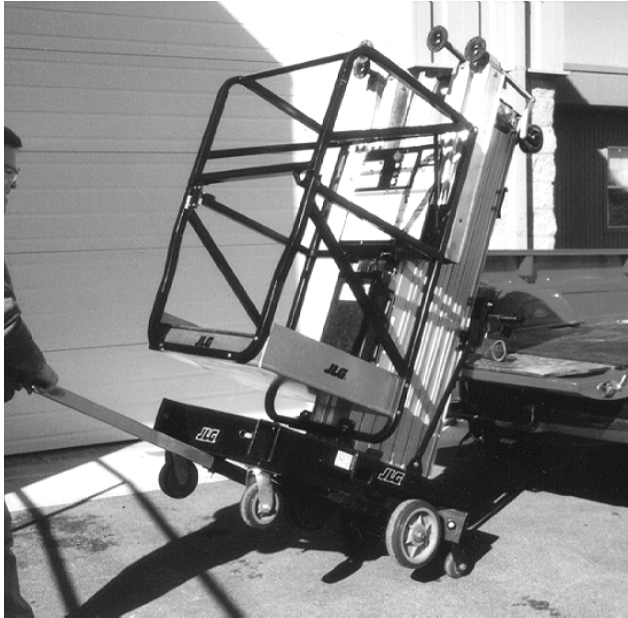
Figur 4-11. Laste maskinen opp på lasteplanet til en pickup.
