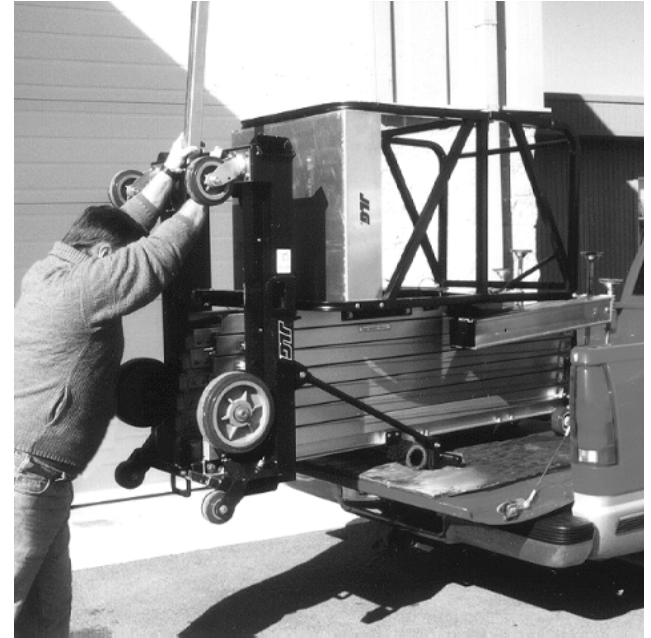
Figur 4-11. Laste maskinen opp på lasteplanet til en pickup.
