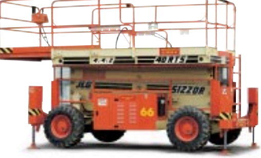
Type: JLG 40 RTS 4WD Arbeidsh.: 14 m. Plattformlast: Fra 340 - 680 kg. Drift: Diesel. Minste bredde:229cm
