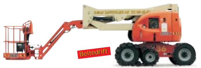
Type: JLG 450AJ Semi-track Drift: Diesel. Arbeidshøyde: 16 meter. Kurvlast: 230 kg. Minste bredde: 198 cm. Transporthøyde: 224 cm
