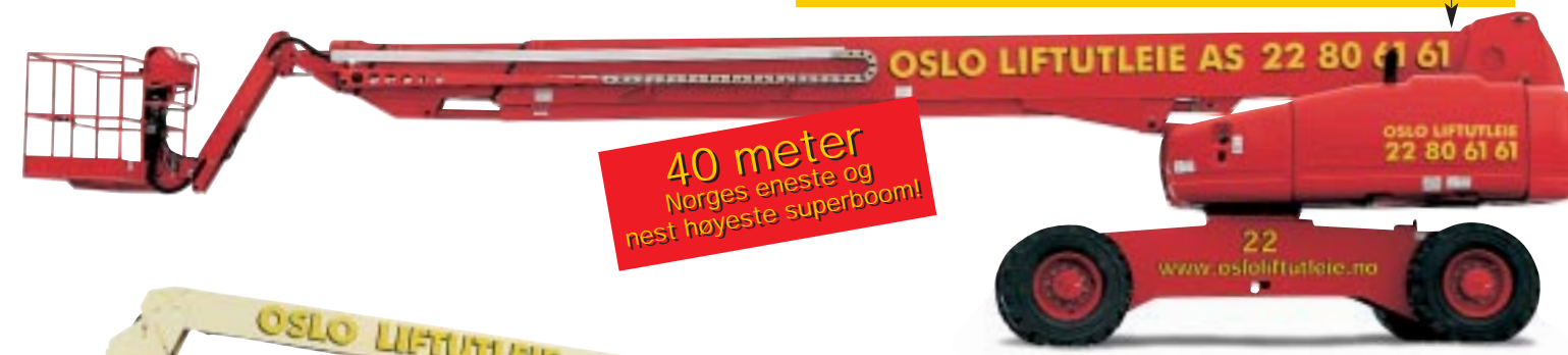
Type: Genie S125 4WD Arbeidshøyde: 40 meter. Kurvlast: 230 kg. Drift: Diesel. Minste bredde: 260/350cm. Transporthøyde: 307 cm
